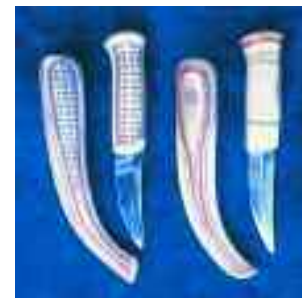
Hornmesser von Esse Poggats. Die Scheide wird in zwei Teilen aus Horn gemacht, die dann zusammengeleimt oder genietet werden.
